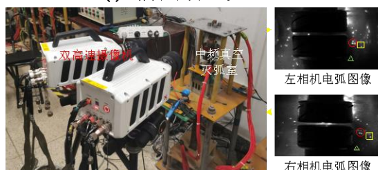
图1 双目视觉中频真空电弧实验系统
